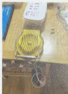
はくの作った「やわらかさのそく定規」3号 つるした紙コップの中に重りを入れていき、豆がスライサーで切れたら、紙コップの重さをはかる。この後、ビー玉では重さが足りなくなって、[とう明のケースにお金を入れた重り]を作る
