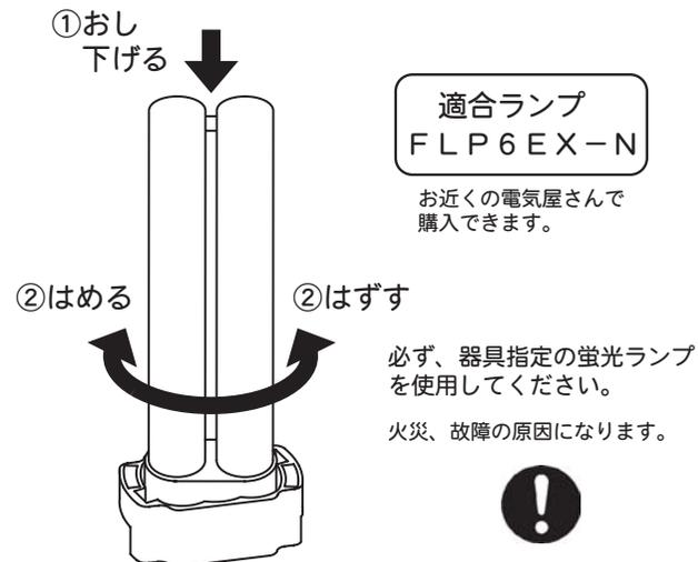
蛍光ランプを交換する際は、ランプの根元を持って回してください（蛍光管が破損するおそれがある為を無理に捻らないでください。）
